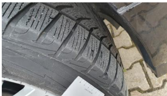
Fot. 32 Opona przednia prawa (Wgniec./Odształ. 1)
