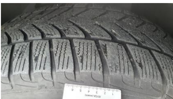
Fot. 43 Opona przednia lewa (Wgniecie./Odształ.)
