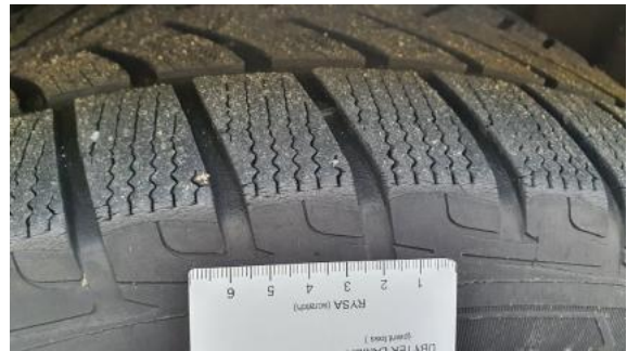
Fot. 38 Opona tylna lewa (Wgniecie./Odształ.)
