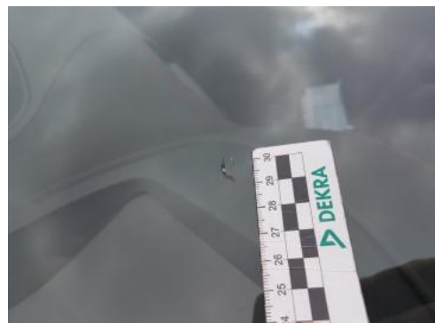
Fot. 24 Szyba czołowa (Pęknięcie/Rozerwanie)
