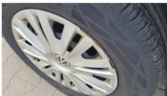
Fot. 40 Kołpak przedni L - Pęknięcie/rozerwanie 1
