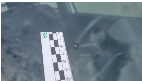
Fot. 31 Szyba czołowa - Rysa/odprysk 1
