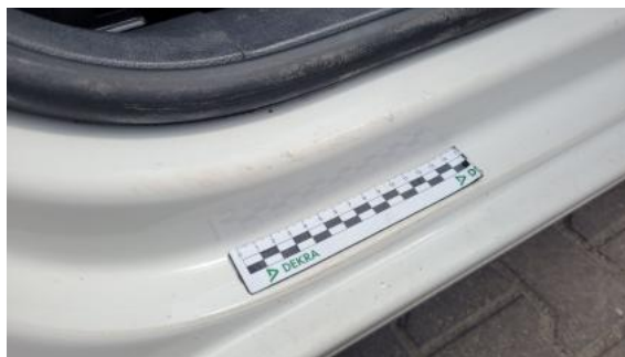
Fot. 34 Próg P - Rysa/odprysk 1
