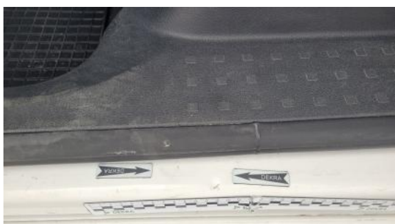
Fot. 39 Próg L - Wgniecenie/odkształcenie 1
