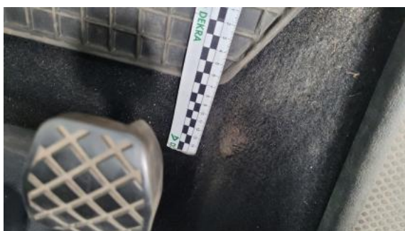
Fot. 39 Wykładzina podłogi - Pęknięcie/rozerwanie 1
