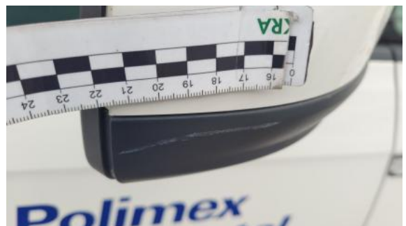
Fot. 32 Lusterko zew P - Rysa/odprysk 1
