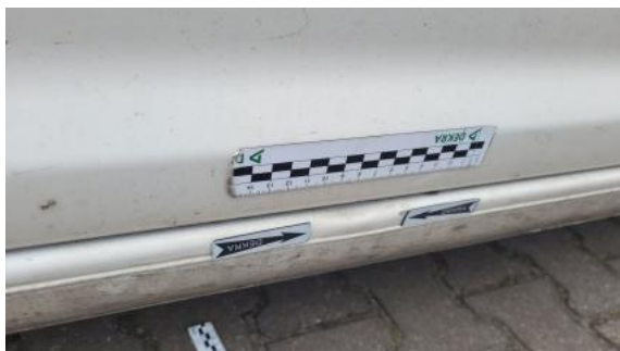
Fot. 33 Próg P - Wgniecenie/odkształcenie 1
