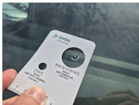
Fot. 32 Szyba czołowa - Pęknięcie/rozerwanie 1
