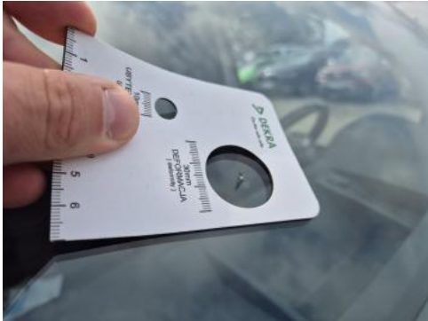
Fot. 33 Szyba czołowa - Pęknięcie/rozerwanie 2
