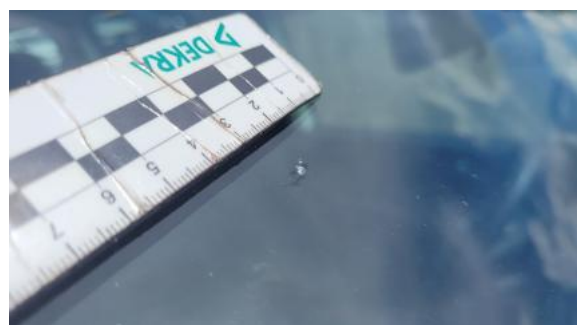
Fot. 32 Szyba czołowa - Rysa/odprysk 1
