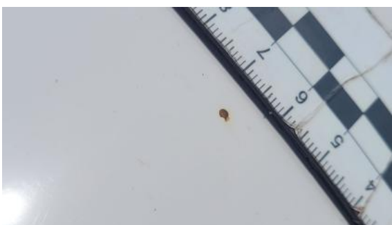
Fot. 31 Pokrywa komory silnika - Rysa/odprysk 1
